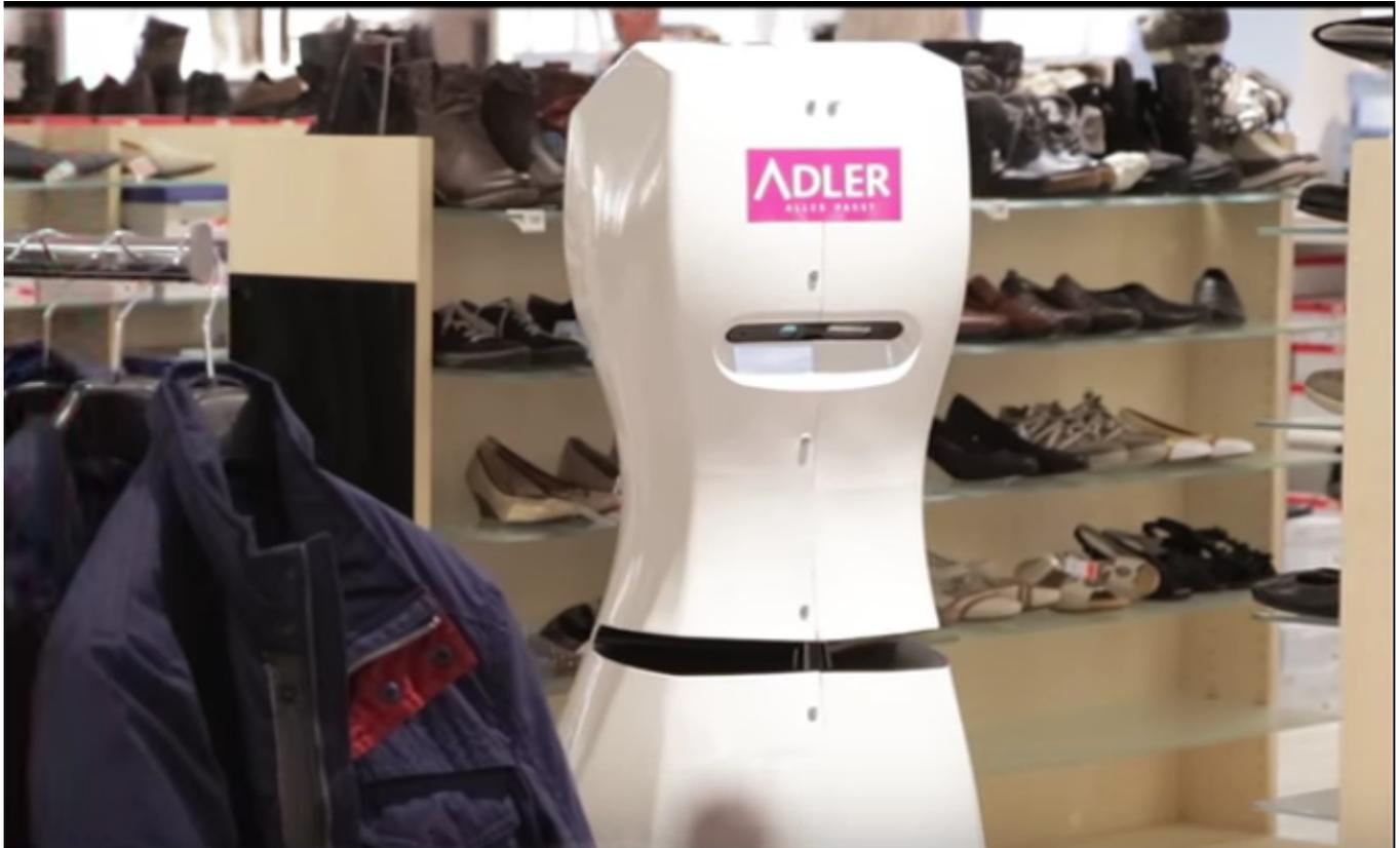
Ein neuer Kollege aus Glasfaser und Metall – für das Verkaufsteam im Adler-Modemarkt Erfurt ist das seit einigen Wochen Normalität. Sein Name ist Tory und er ist der erste festinstallierte RFID-Inventur-Roboter der Welt. Entwickelt wurde er von dem Robotik-Unternehmen MetraLabs aus Ilmenau, die bereits 2008 als Partner im Future Store der Metro Robotik-Szenarien am PoS gezeigt haben
