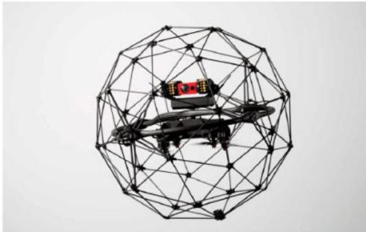
kilometer. Durch Kontrollalgorithmen lernt die Drohne zudem aus Kollisionen. Und im Gegensatz zu Standarddrohnen ist ELIOS unfähig: Ein Gitterkäfig, der wie ein Ball um die Drohne geformt ist, schützt Mensch und Tier vor den Rotorblättern.
